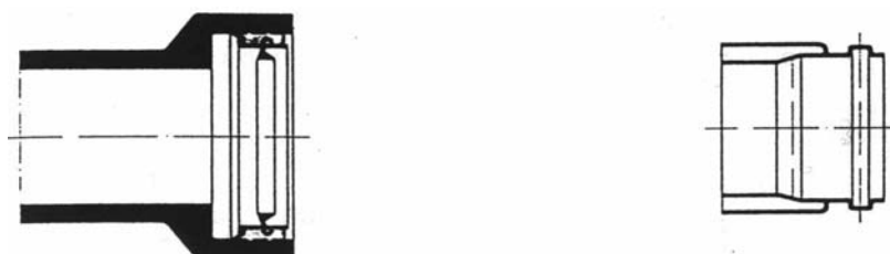
раструб бетонной трубы с резиновым уплотнением
